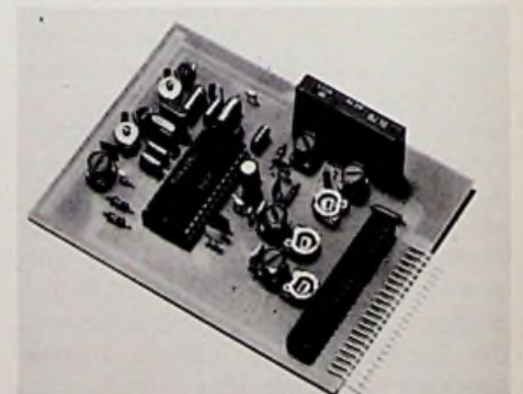
Bild 2: Außenbeschaltung einer kompletten Farbdifferenzschnittstelle für alle Normen (Valvo-Pressbild)
